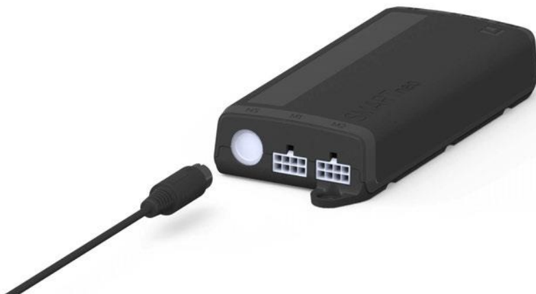
Fig. 11: Aansluiting op de SMARTneo-besturingsbox
