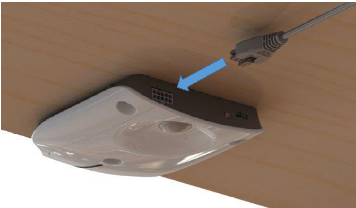
Fig. 15: Sluit de mini-fit aan op de LOGIClink
