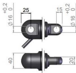
Polyamide (PA) Max. statische belast. 4700 N Max. belasting 3100 N (overbrenging 1:24)
