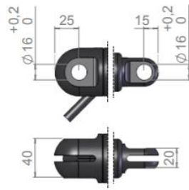
PA met sleuf Max. statische belast. 4700 N Max. belasting 3100 N (overbrenging 1:24)
